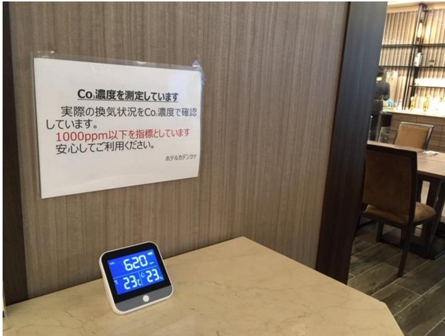
レストランで実際の換気状況を確認するCo2濃度を測定しています
